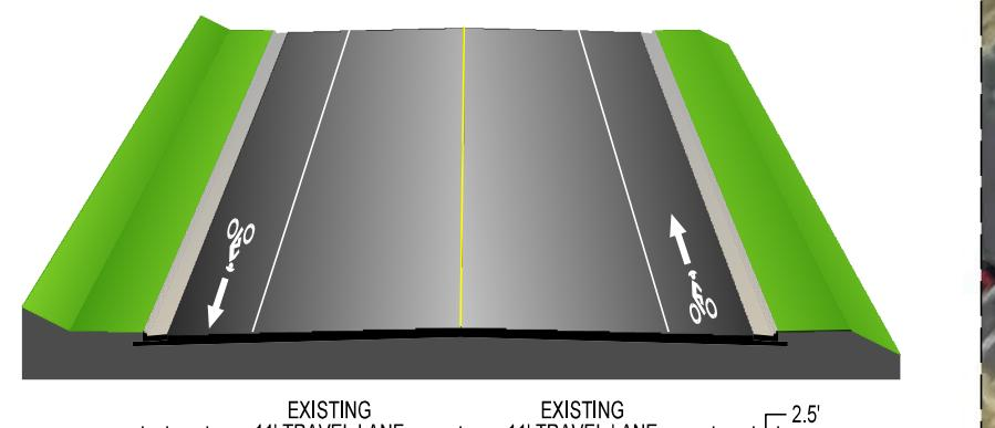
**BIKE LANE EXISTING CURB AND GUTTER AND ROADWAY CROWN TO REMAIN.
